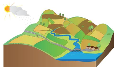
**Le chenal et la noue enherbés ont pour fonction de guider, d'épurer et de stocker les eaux de ruissellement. Ils permettent aux sédiments de se déposer.**
