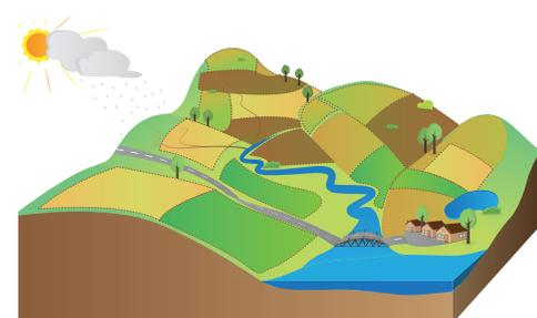
La mare tampon a pour principal objectif de stocker les eaux de ruissellement en complément de la mise en place d'aménagements visant à limiter les ruissellements. Elle peut être temporaire ou permanente notamment en fonction du type de sol. C'est un habitat écologique intéressant.
